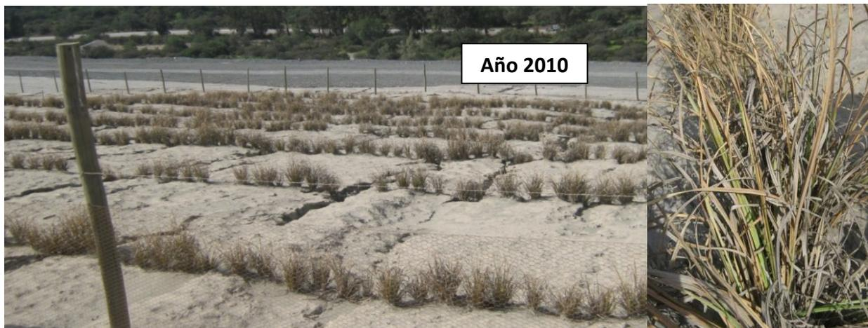
**Figura 6.-** Ensayo piloto VGT en tranque de relave. Mina El Soldado. Monitoreo año 2010
